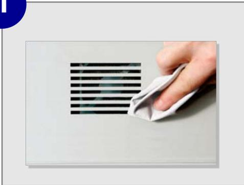
Reinigen Sie das Gehäuse des Druckers rund um den Abluftschlitz mit einem feuchten Tuch und lassen Sie es trocknen.
